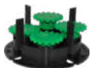
Stelzlager, Vollstück höhenverstellbar von 35–50 mm, ergibt 2 mm breite Fugen. Höhe der Fugenstege kann individuell z. B. mit einem Seitenschneider gekürzt werden. Rand- und Eckstücke können herausgebrochen bzw. geschnitten werden. (Nur für Granitkeramik Platten geeignet)
